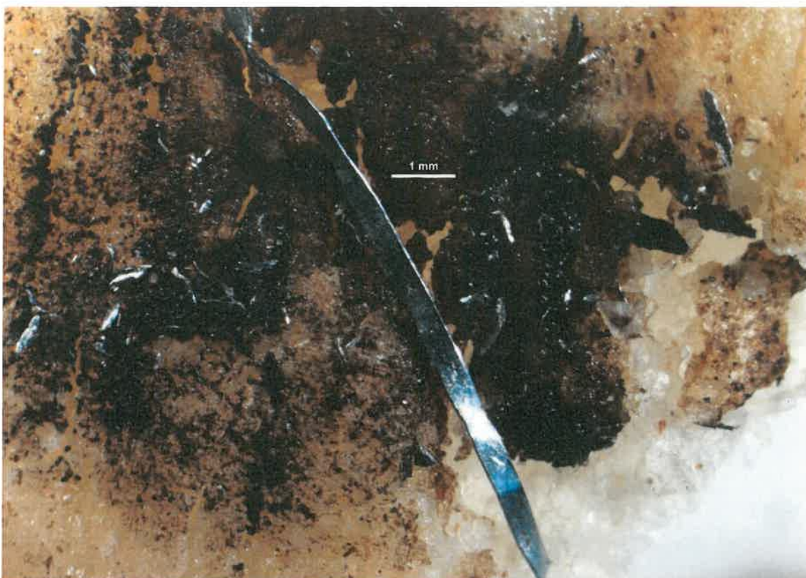
Foto 6: Vergrößerung von Verunreinigung 1 auf Brot A im Vergleich zu hinzugefügtem Metallfaden der Stahlwolle
